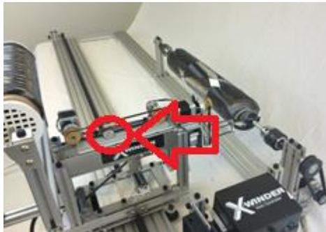
Abbildung 35: Montage Rotationskopf
