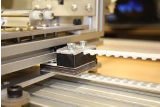
Abbildung 31: Zahnriemenspannung
