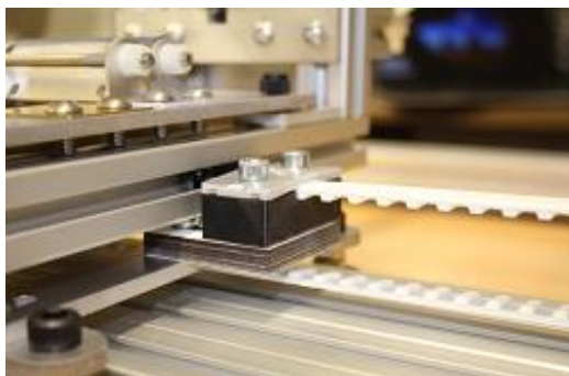
Figure 31: Tension de la courroie crantée
