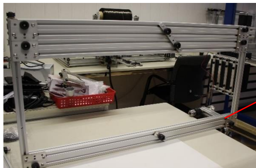
Figure 27: Montage du cadre de base
