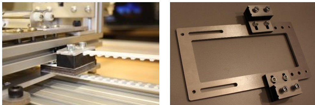
Figura 31: tensione della cinghia dentata
