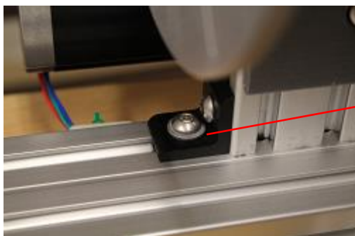
Figura 28: Montaggio del mandrino
