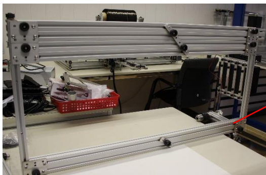
Figura 27: Montaggio del telaio di base
